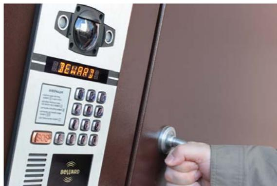
Домофон BEWARD легко устанавливается на новом объекте, либо в уже существующую координатно-матричную систему. При этом с минимальной настройкой сразу обеспечивается базовый функционал с поддержкой любых координатно – матричных абонентских устройств.
